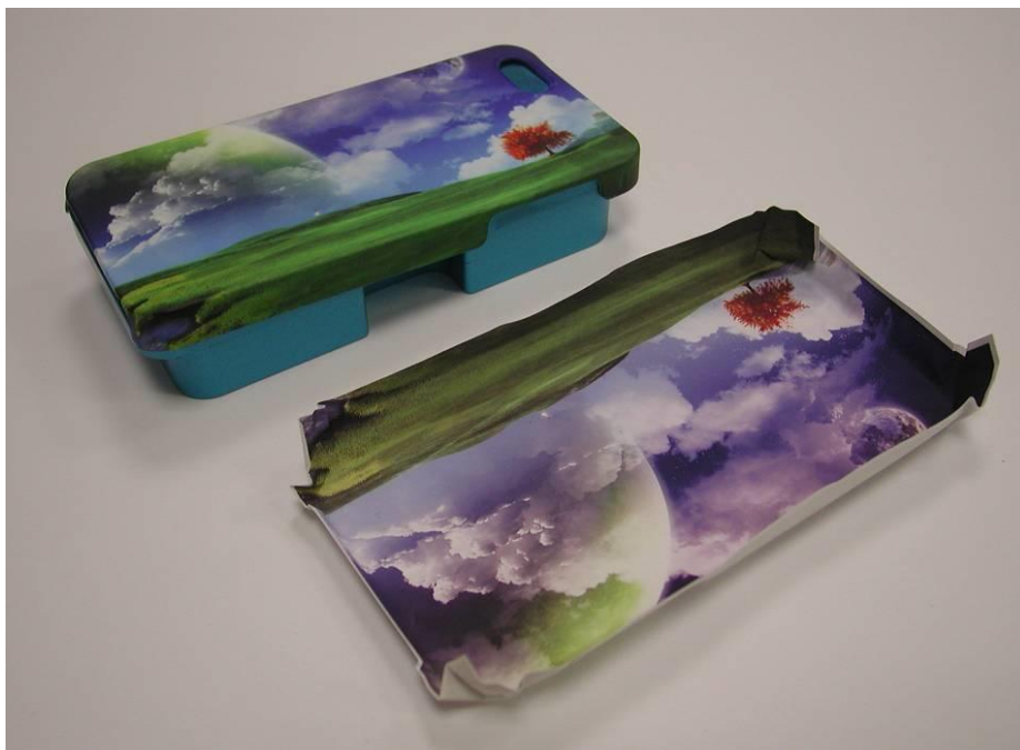
Оправка для формования чехла
